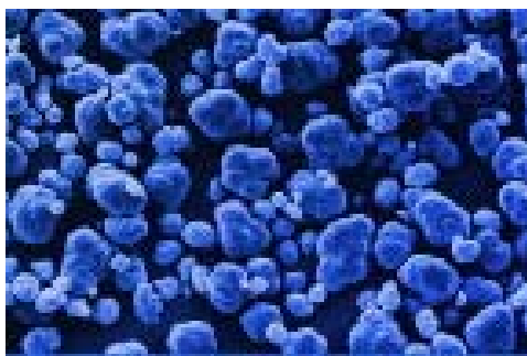
Рис. 1-6 Полиамидные частицы под микроскопом [4]
