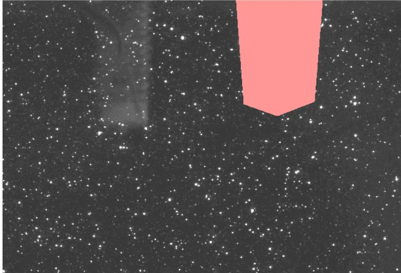
Рис. 2-16 Изображение-маска (фрагмент). Красным цветом закрашен неподвижный объект
